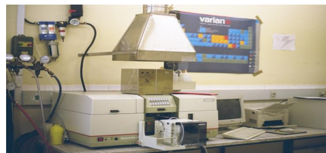
Flame Atomic Absorption Spectrometer (Varian SpectrAA 200)
